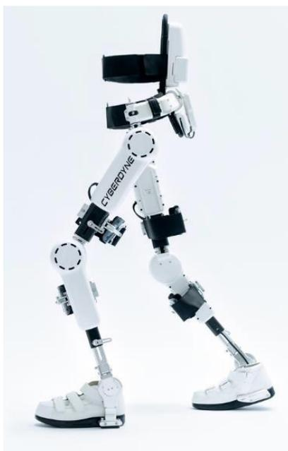
Figura 1. Hybrid Assistive Limb. Fonte: Cyberdyne Inc.
